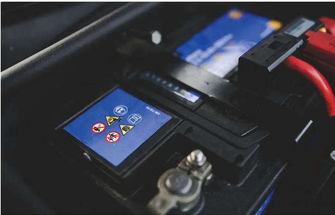
A l'intérieur d'une batterie de voiture, les réactions chimiques sont ralenties par un thermomètre qui frôle le zéro et les températures négatives. Dès la baisse de ces dernières, la batterie peut perdre jusqu'à 30 % de ses capacités, réduisant alors la puissance de démarrage. De même, le froid risquera d'endommager encore plus les composants internes si la batterie est déchargée.
